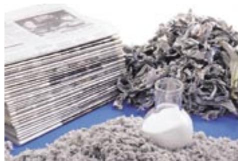
Zellulosedämmstoff besteht aus reinem Tageszeitungspapier und einer Mischung aus Borsalz
